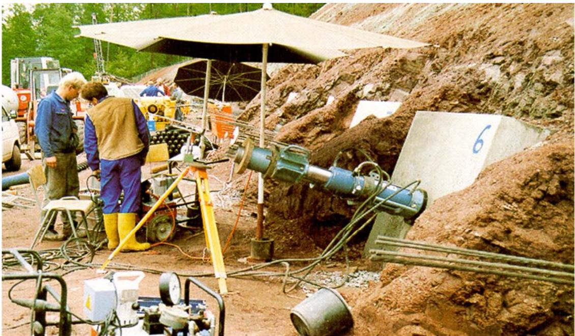
Bild 5-3: Ankerprüfung [2]
