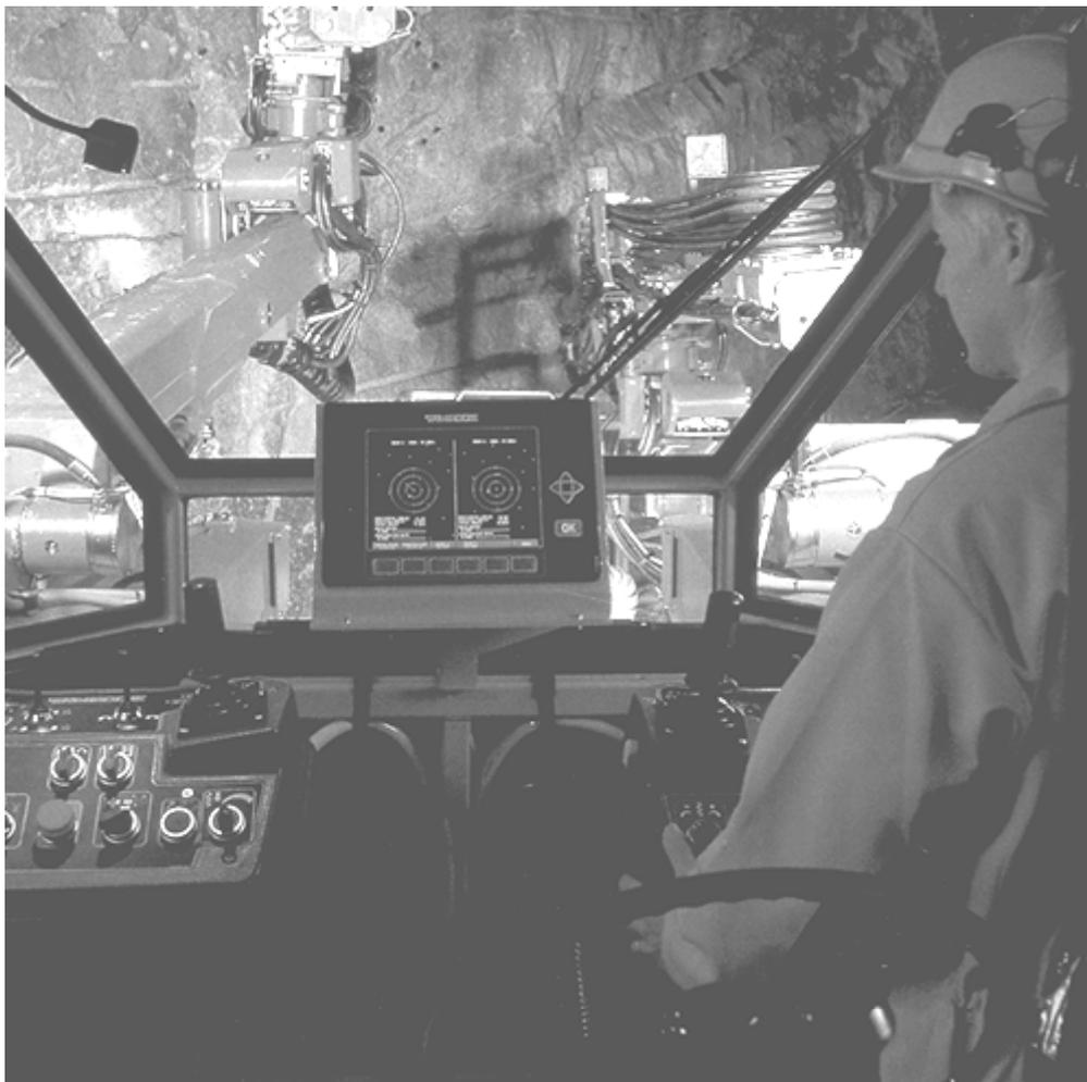
Bild 2-11: Steuerstand eines roboterisierten Bohrgerätes von Tamrock
