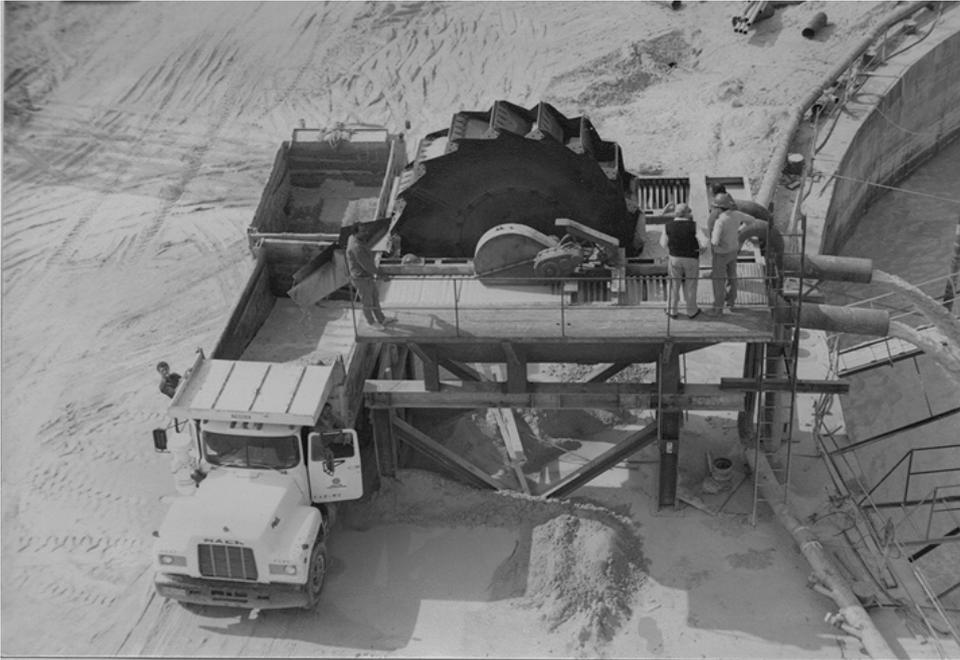
Bild 6-5: Sandseparationsrad
