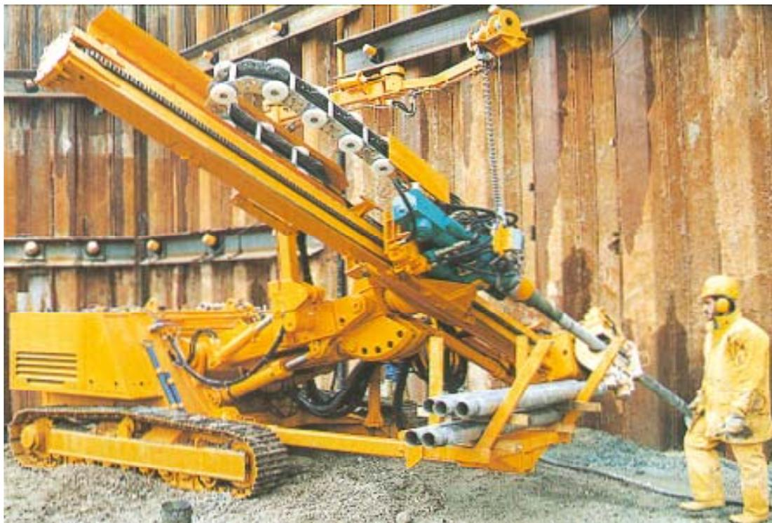
Bild 4-8: Ankerbohrgeräte (unten: mit Verrohrungslager) [2]
