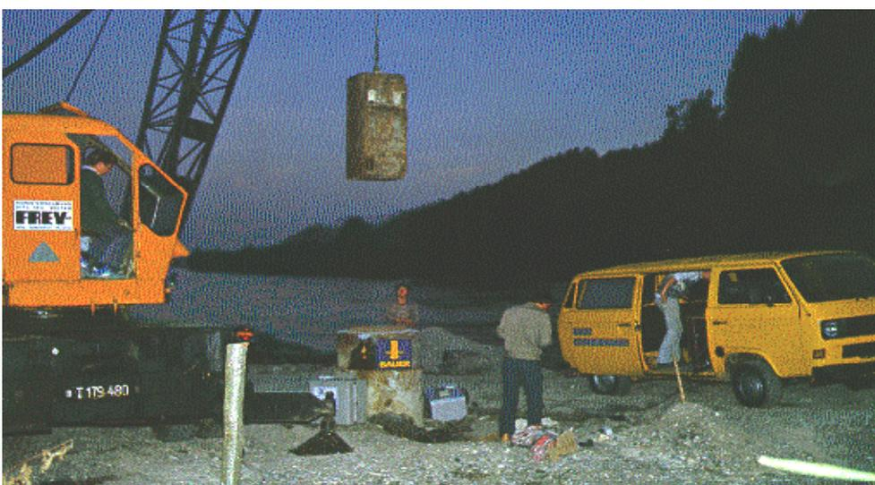
Bild 9-11: Pfahltragfähigkeitsuntersuchung mittels Fallgewicht
