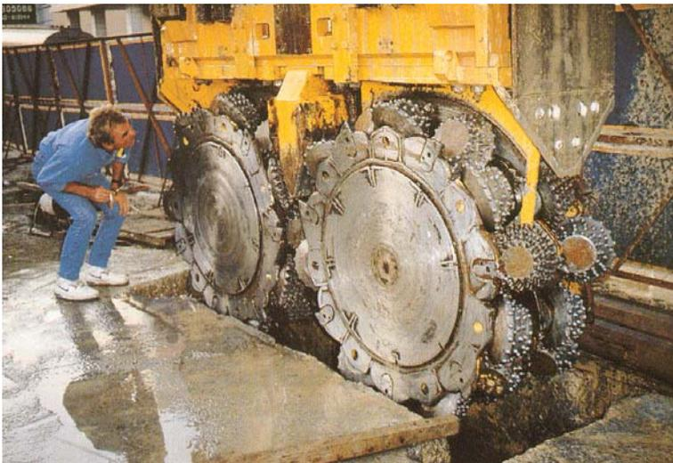
Bild 2-12: Fräse mit rollenmeisselbestückten Schneidrädern zum Durchhören von Findlingen und Fels [9]
