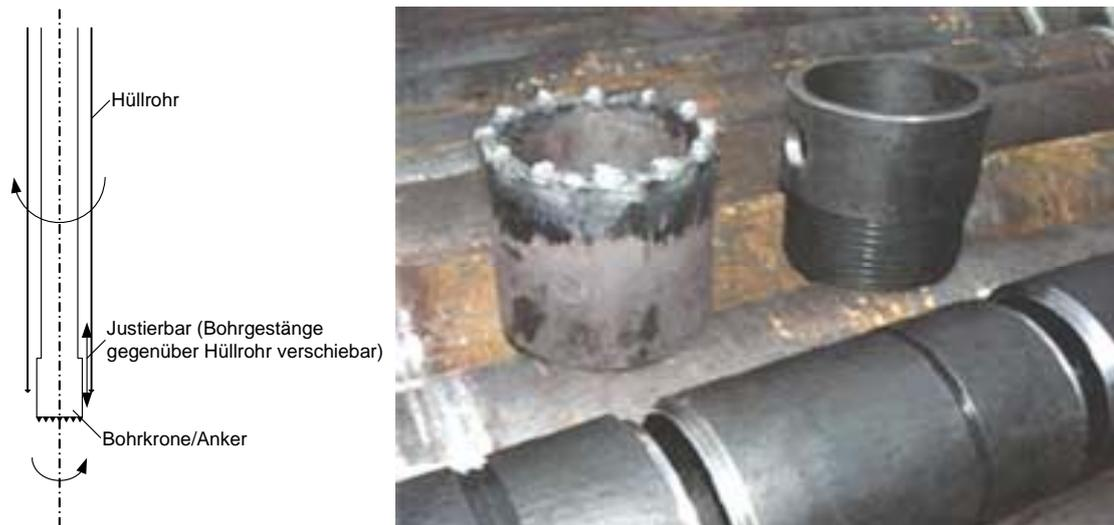
Bild 4-4: Verrohrtes Dreh-Schlagbohrverfahren, Bohrkronen mit Besatz
