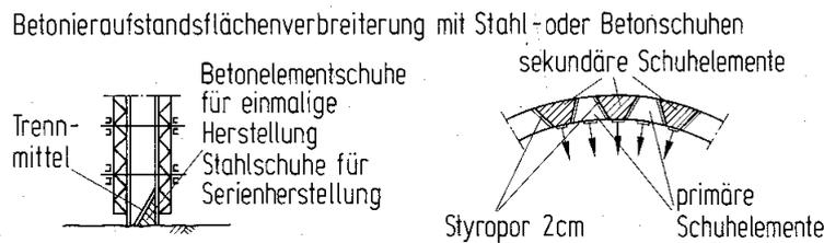
Bild 3-7: Verbreiterung der Aufstandsfläche während des Betonierens mittels Schuhelementen [1]
