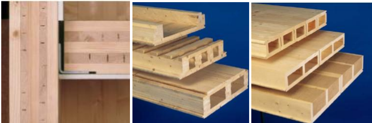
Bild 67: Brettsperrholz sowie zusammengesetzte Hohlprofile [71]
