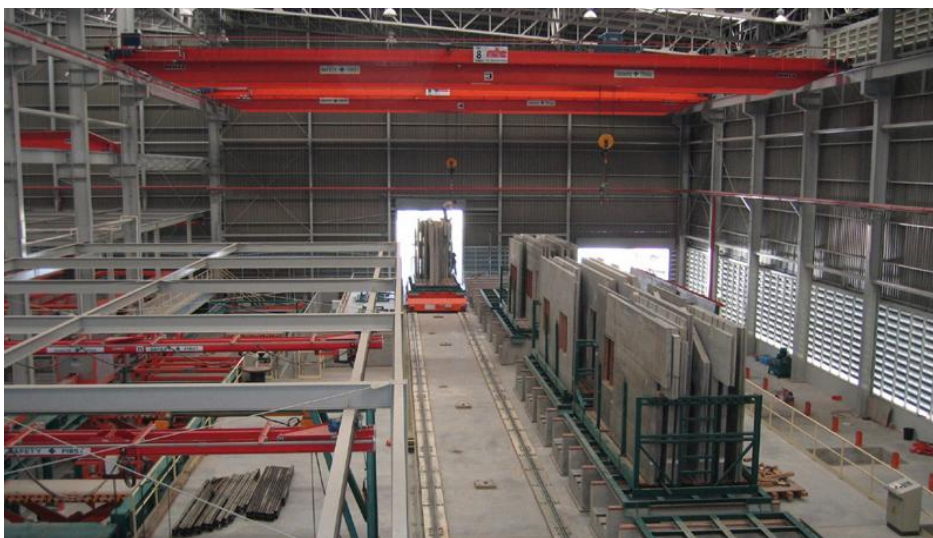
Bild 50 Automatisierter, kran- und gleisgeführter Transport [83]
