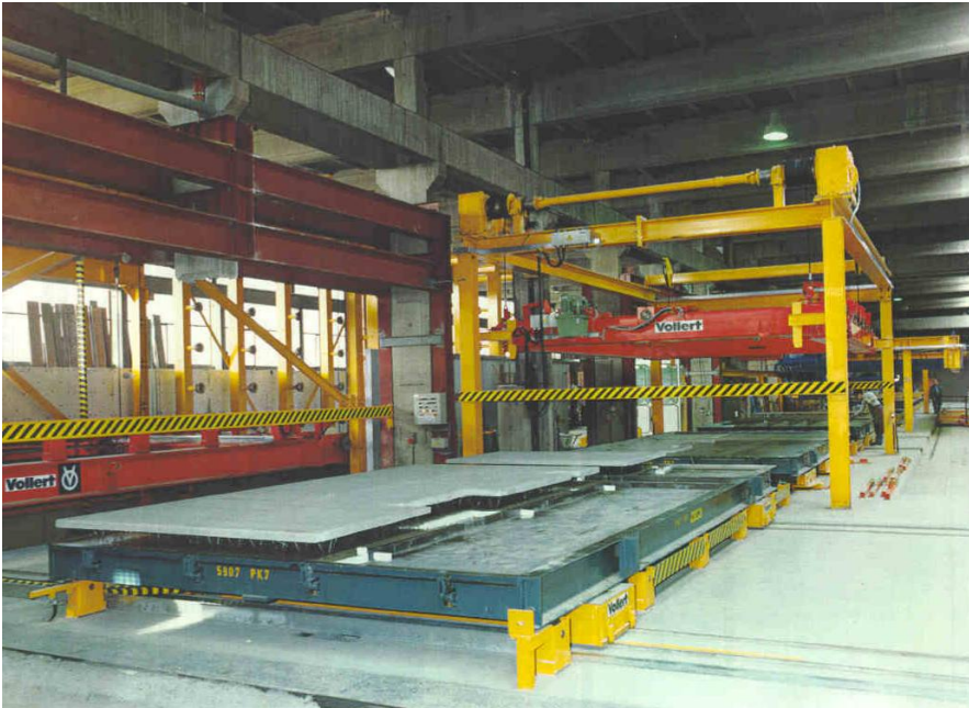
Bild 39: Herstellung von Deckenelementen mittels Umlaufproduktionsverfahren [41]
