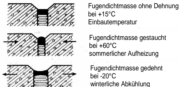
Bild 74: Änderung der Fugenbreite [4]
