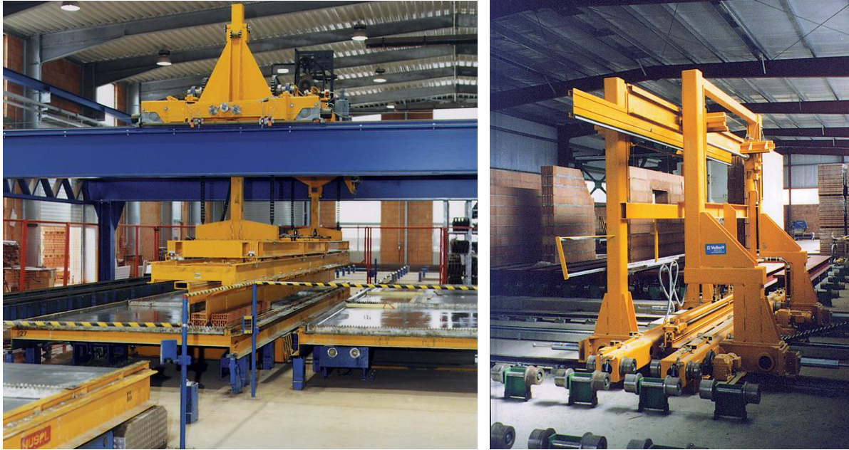
Bild 97: Herstellung und Transport von Mauerwerks-Elementen [83]
