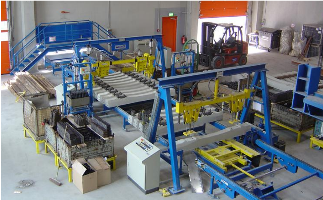
Bild 53 Automatisierte Fertigungsanlage für Gleisschwellen (2) [83]
