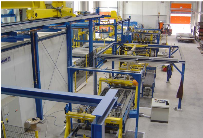
Bild 52 Automatisierte Fertigungsanlage für Gleisschwellen (1) [83]
