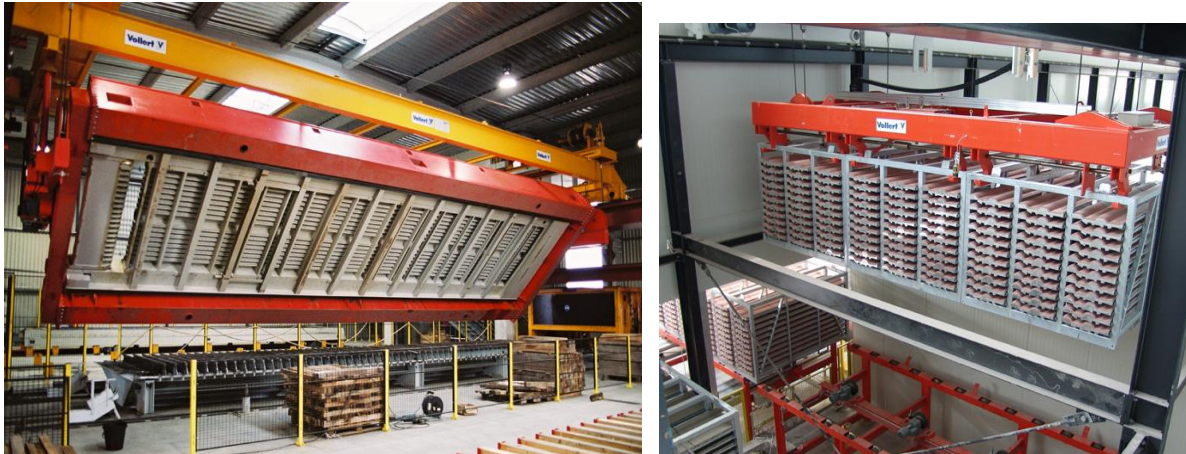
Bild 43: Herstellung von Betondachsteinen [83]
