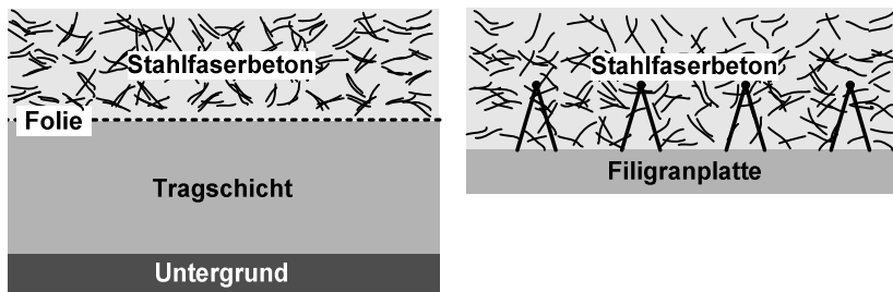
Bild 12: Stahlfaserbeton als Aufbeton auf einer Filigrandeckenplatte oder als Bodenplatte
