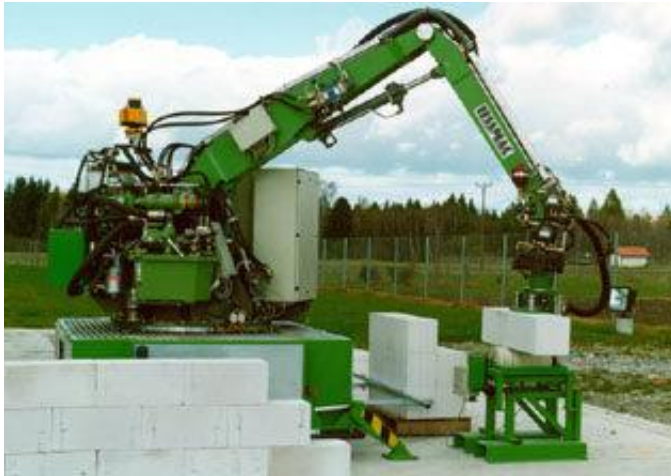
Bild 95: Mauerwerksroboter für den Einsatz auf der Baustelle [10]
