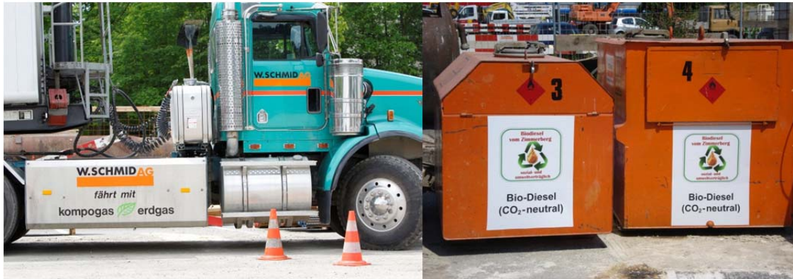
Bild 4-80: LKW mit Kompogas/Erdgas-Motor / Biodiesel-Bautankstelle [Quelle: www.umweltarena.ch]
