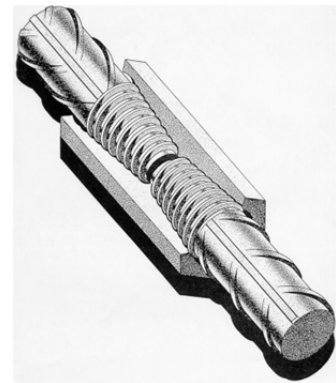
Bild 11-13: Schnitt durch eine konische Pressgewindemuffe [3]
