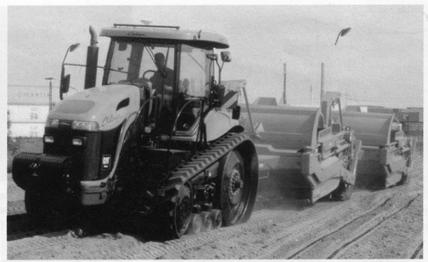
Bild 7-32: Zwei einachsige Anhängescraper, gezogen von einem Raupentraktor [19]
