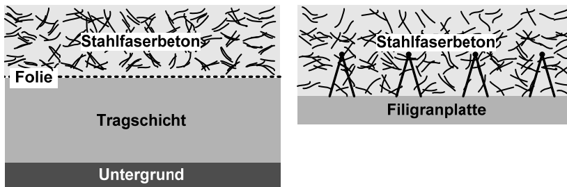
Bild 15-12: Stahlfaserbeton als Aufbeton auf einer Filigrandeckenplatte oder als Bodenplatte
