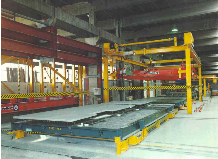
Bild 15-39: Herstellung von Deckenelementen mittels Umlaufproduktionsverfahren [41]
