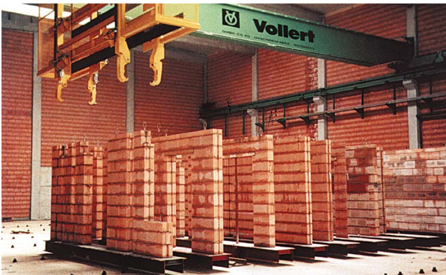
Bild 15-96: Vorgefertigte Wandscheiben aus Mauerwerk [83]
