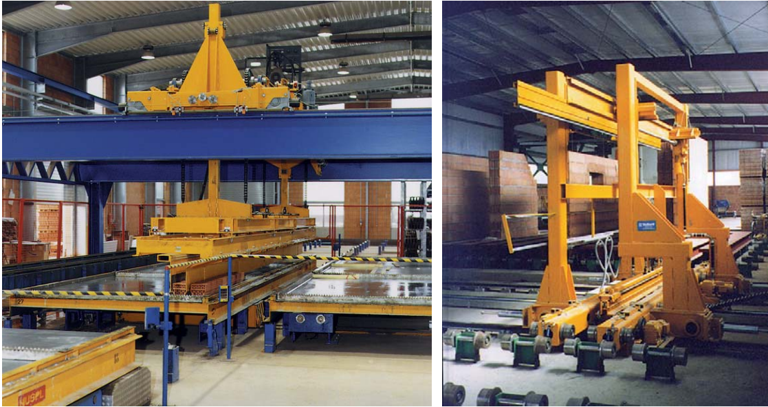
Bild 15-97: Herstellung und Transport von Mauerwerks-Elementen [83]
