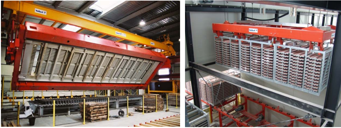
Bild 15-43: Herstellung von Betondachsteinen [83]
