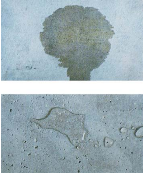
Bild 5–2: unbehandelter Beton (oben) und hydrophobierter Beton (unten)
