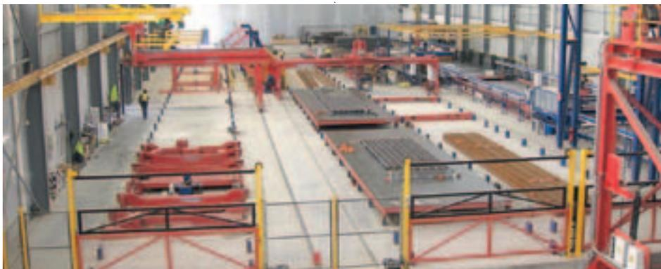
Bild 3: Automatisierte Fertigung von Betonelementen<sup>9</sup>.
