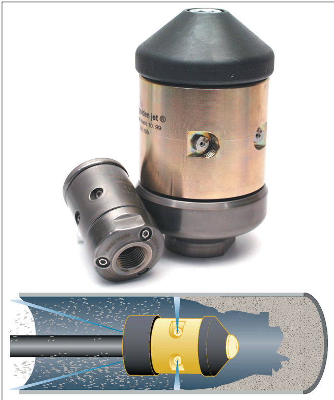
Bild 4. Rotationsdüsen – Radialdüsen mit 4 x 80° Radialstrahlen zur Rohrreinigung; besonders zur Wiederöffnung versinterter Sickerschlitze (mit Genehmigung der ENZ® Technik AG, CH-6074 Giswil)
